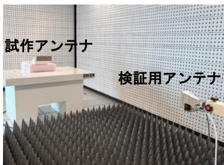
図2 アンテナ性能(電波強度等) 検証の様子
