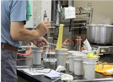
図1 染料選定用染色試験
