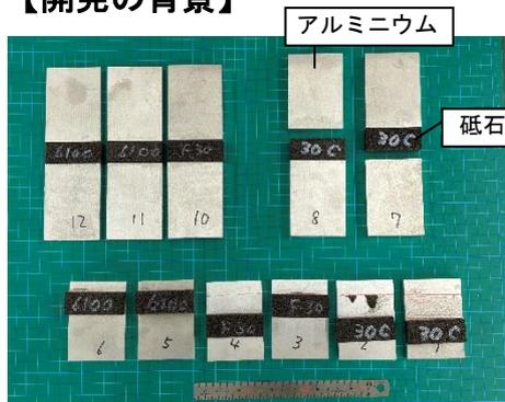
図1 試験片（接合強度評価）
