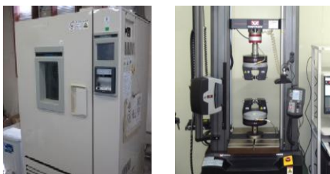
図1 評価に用いた試験装置 (左：恒温恒湿槽 右：万能試験機)
