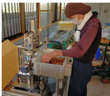
図2 自動傷入れ機の導入
