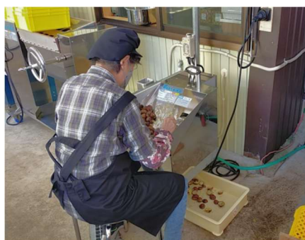
図3 栗の自動圧搾機 (従来はスプーンで手作業)
