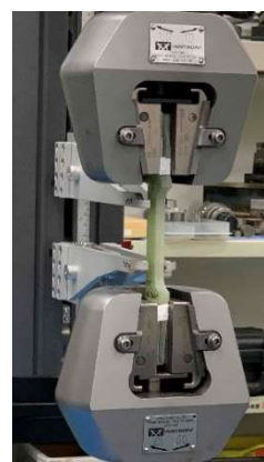
図4 引張試験による強度評価
