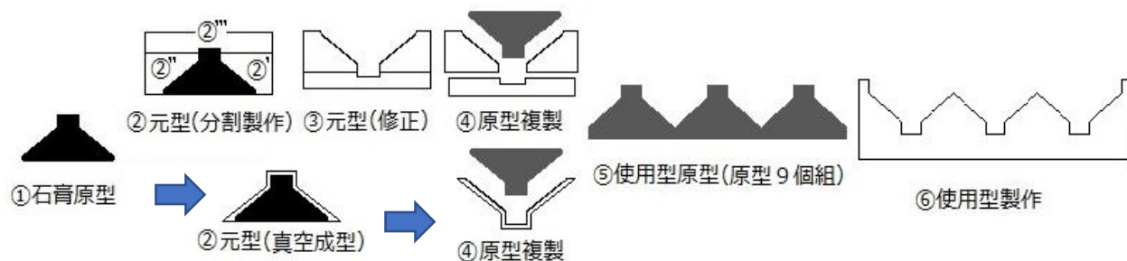
図 1 工程図（上段：すべて石膏で製作した工程 下段：真空成型機を用いた工程）
