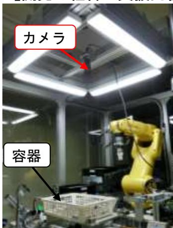
当センターの模擬スマート工場にて、現行の部品洗浄用容器に部品を入れた状態でその位置を正確に認識できるか、事前検討を行いました。その結果、天井にカメラを固定して部品の位置認識を行った場合、容器に設けられた穴の形状と部品形状が似ているため、誤認識する潜在的なリスクがあることや、部品の裏と表を正確に区別することが難しいため、ピッキング後に裏表を判別する必要があることなどがわかりました。また、万が一傾いた部品が混入していた場合でも、傾いていない部品のみを認識し、ピッキングを行うことが可能であることもわかりました。
