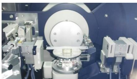
図2 X線回折装置
