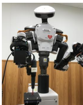
図2 ロボットによる付加力の計測
