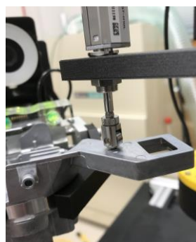
図3 センサによる微細バリの検出
