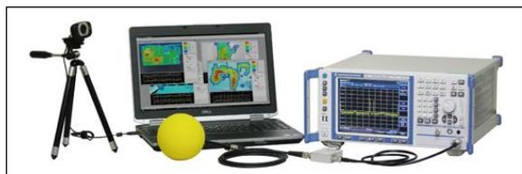
図 2 電磁界可視化装置
