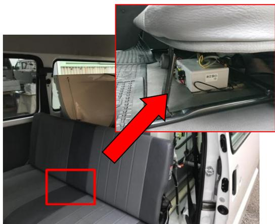
図1 モニタリングシステム設置状況
