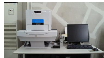
図2 RoHS指令適合に関する 分析試験装置
