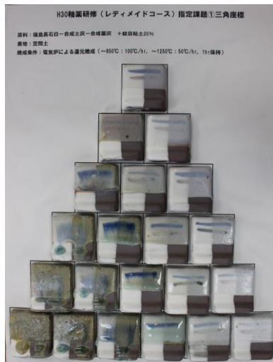
図1 釉薬テストピース（左から「三角座標」「色釉」「ゼーゲル座標」）
