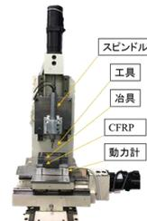
図 2 CFRP 加工機
