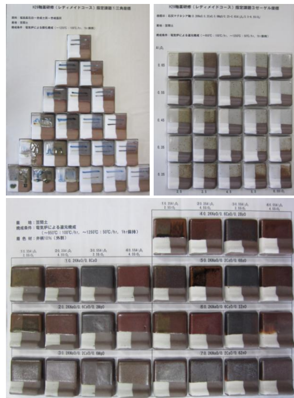
図 1 レディメイドコース釉薬試験片
