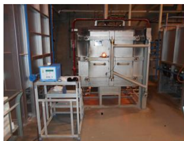
図 2 試験焼成状況 （還元ガス濃度測定）
