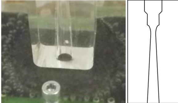
図 1 ベンチュリ管式マイクロバブルによる洗浄と模式図
