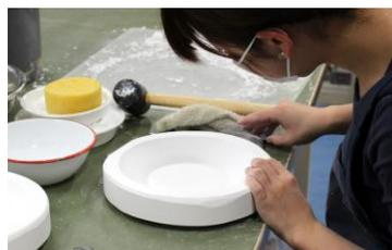
図 2 鑄込み型の試作
