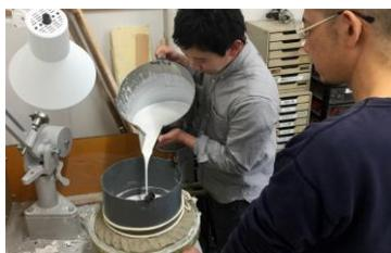
図 1 石膏原型ろくろによる試作
