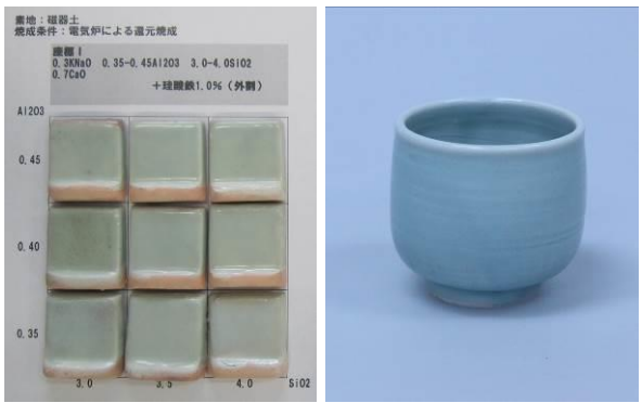
図 2 「青磁釉の開発」試験片および試作品
