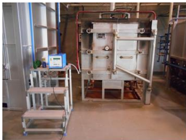
図 1 試験焼成状況（還元ガス測定）
