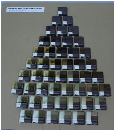
図 1 箱田石を用いた釉薬試験片 (三角座標)
