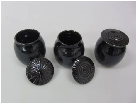
図 2 箱田石を用いた黒釉試作品 (塩壺)
