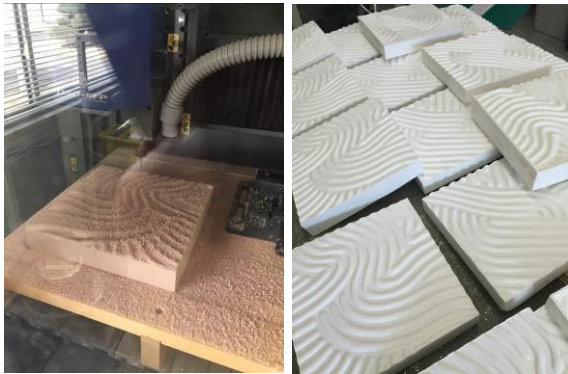
図 2 NC による原型切削と石膏型の複製
