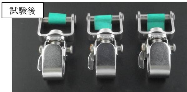
図 3 塩水噴霧試験後サンプル
