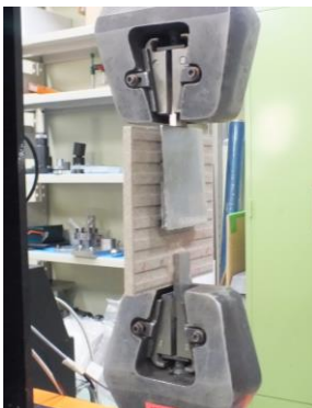
図2 支持金具の強度試験
