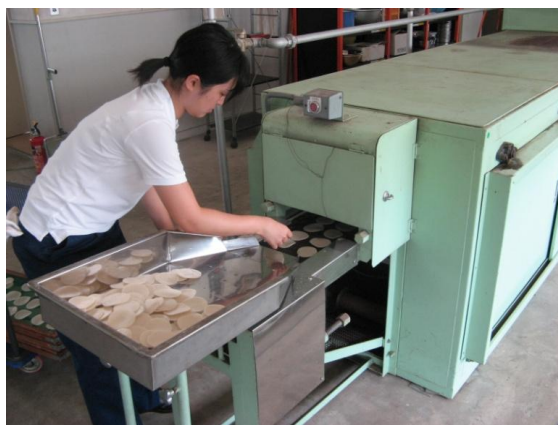
図 1 煎餅製造技術の研修 (煎餅生地を焼成窯に入れる作業)
