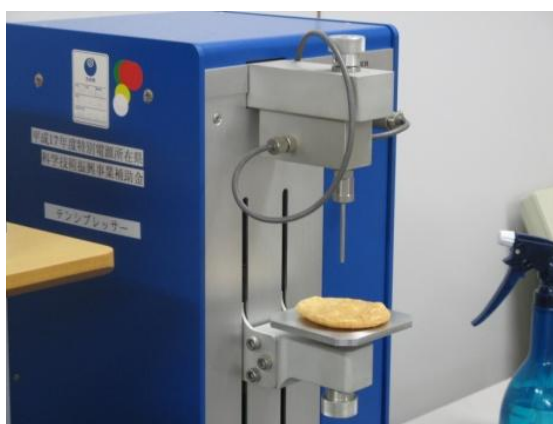
図 3 煎餅の硬度測定機器
