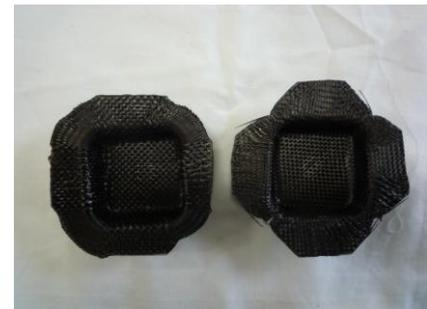
図2 プレス後のCFRPシート
