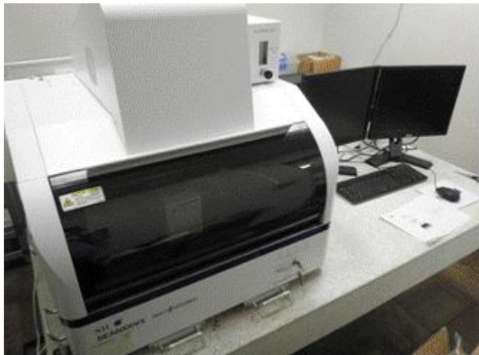
当センターでは蛍光エックス線膜厚計を使用した膜厚測定を行っております。また、種々の素地と皮膜の種類に対応するために様々な標準サンプルを用意しています。
