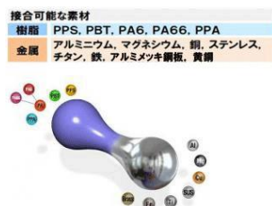
図 1 開発した接合技術の適用材料
