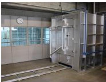
図 2 ガス炉 (1.5m<sup>3</sup>)
