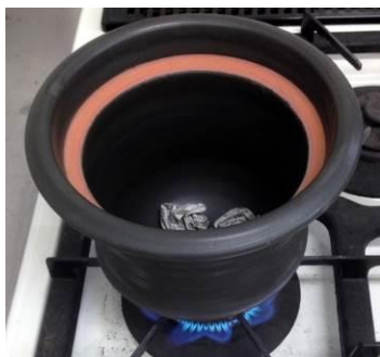
図1 空焚きによる耐熱試験
