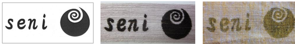
図 1 試作試験結果 (左：図案 中央：手紬糸への捺染染色結果 右：試織結果)
