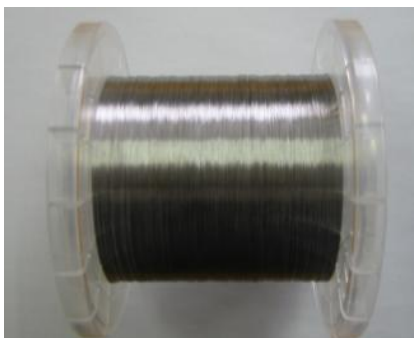
図3 チタン合金極細線のポビン巻
