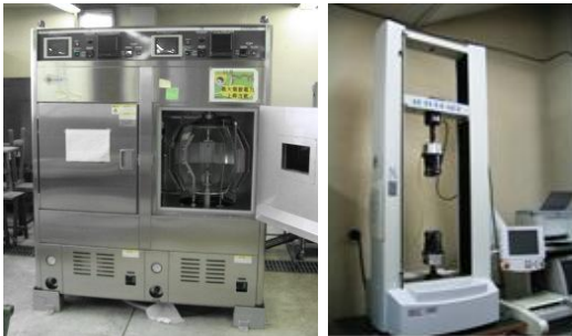
図1 依頼試験に用いた「耐候試験機」(左)と「万能試験機」(右)
