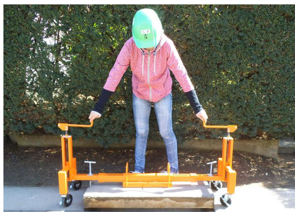
図 2 開発した U 字溝蓋昇降機
