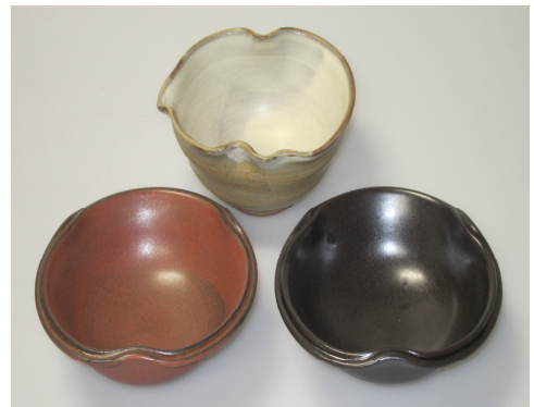
図 2 笠間単味を含む釉薬の試作品 (左:柿マット釉, 中:白マット釉, 右:黒釉)
