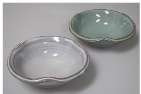
図 3 手越陶石を含む釉薬の試作品 (左:藁白釉, 右:青糠釉)
