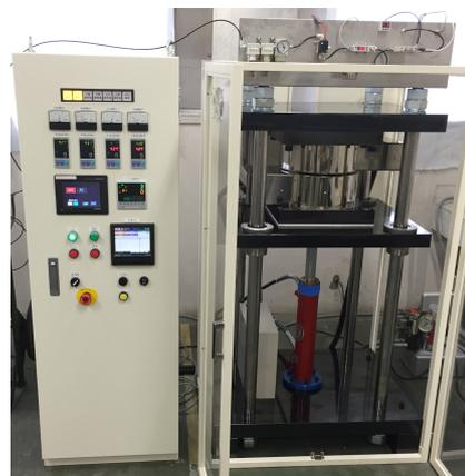
図 2 成形試験機 (ブロー成形機)
