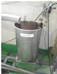
図 1 めっき廃液処理事例 (蒸発濃縮)
