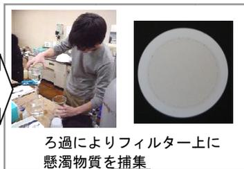
ろ過によりフィルター上に懸濁物質を捕集
