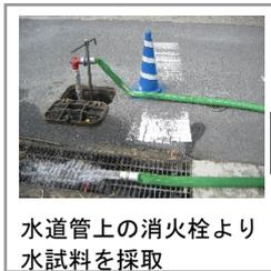
水道管上の消火栓より水試料を採取
