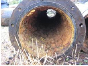
図 1 劣化の一例：内面が腐食した水道管
