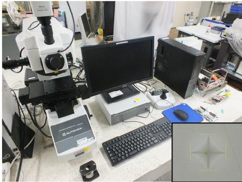
図 1 ビッカーズ硬さ試験機と塗膜硬さ性能評価例（右下）
