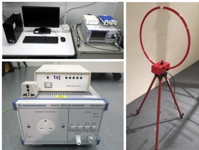
図1 電界強度測定システム (JKA 補助)
