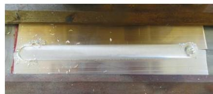
図 2 異種金属の FSW 試験
