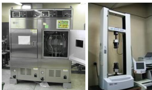
図3 依頼試験に用いた「耐候性試験機」(左)と 「万能試験機」(右)
