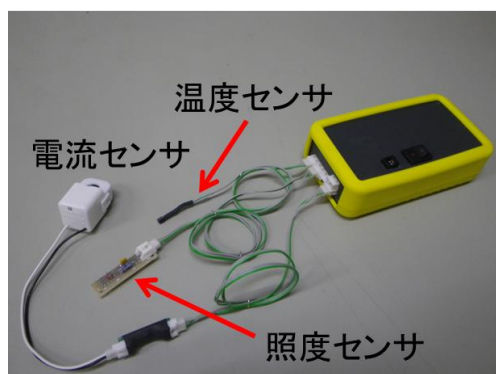
図 1 製作したセンサモジュール
