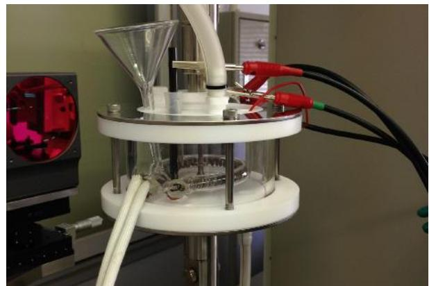
図2 応力腐食割れ実験の様子
