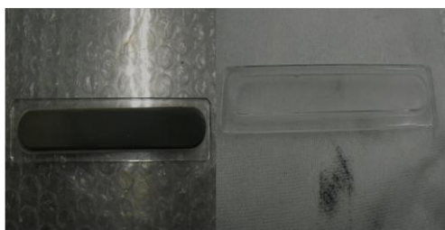
図3 洗浄事例 石英部品 (左：洗浄前 右：洗浄後)
