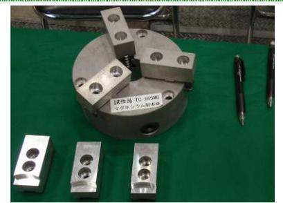
振動吸収性利用旋盤チャック
