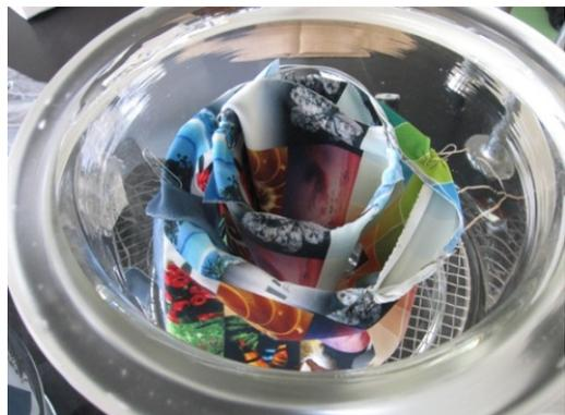
写真1 ホルムアルデヒド放散試験
