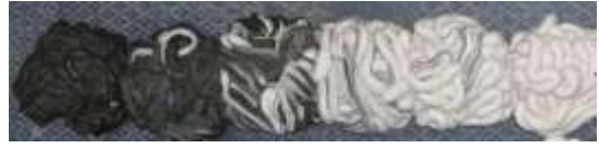
図1 パージ工程での材料の色変化 前樹脂：黒、後樹脂：白
