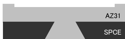
図3. 異種金属の締結 (上: AZ31 下: SPCE)
